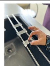
Penggunaan S Rack mengurangkan risiko slaid spesimen jatuh atau pecah
