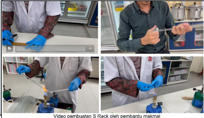
Video pembuatan S Rack oleh pembantu makmal
